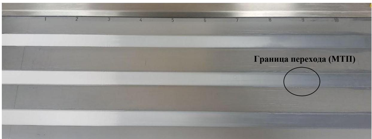
Рисунок 3.4.1 - Внешний вид пленки, полученной через сутки после нанесения дисперсии на термоградиентную пластину прибора
