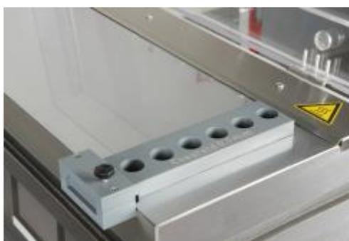
Рисунок 2.4 - Устройство для нанесения дисперсии на измерительную пластину
