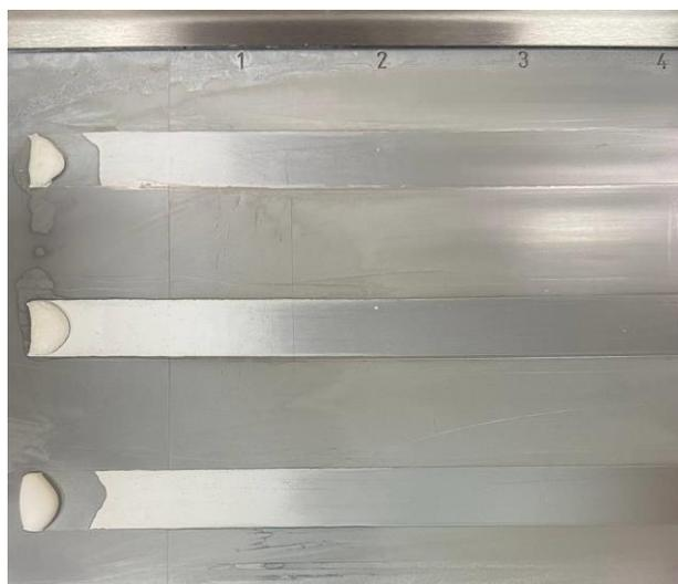
Рисунок 3.4.3 - Изображение пленки, полученной после нанесения дисперсии (синтезированной с добавлением  $ZnCl_2$ ) на термоградиентную пластину для определения МТП
