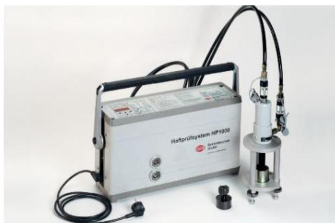
Рисунок 2.7 - Прибор для измерения адгезии Bond Strength Testing System HP 1000 – Herion Systemtechnik GmbH
